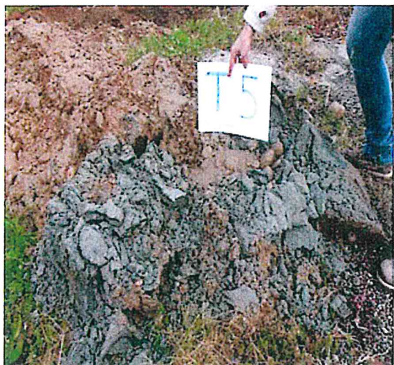
Illustrazione 19: cumulo del terreno scavato, con in primo piano la sabbia e sullo sfondo il tout venant
