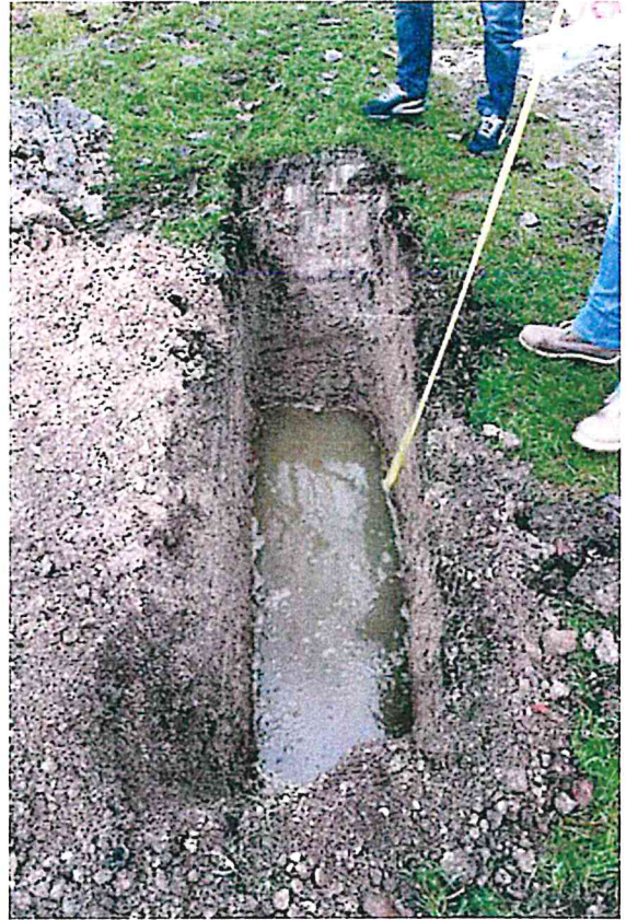
Illustrazione: 10: visione longitudinale trincea con falda presente sul fondo
