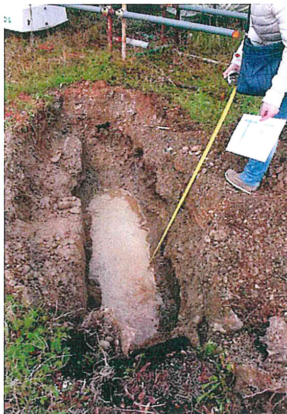
Illustrazione 18: visione completa trincea con fondo saturo d'acqua
