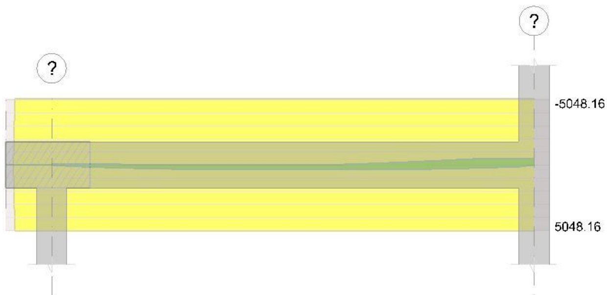
Diagramma verifica stato limite ultimo flessione
