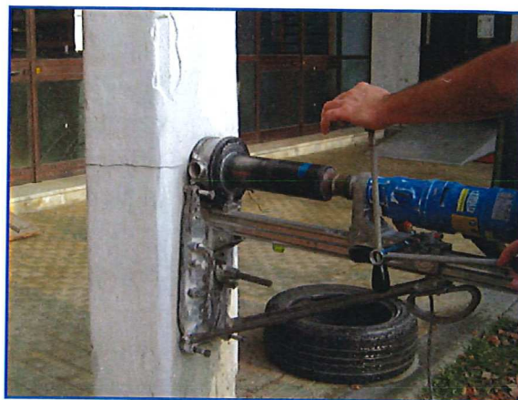
Esecuzione carotaggio su pilastro
