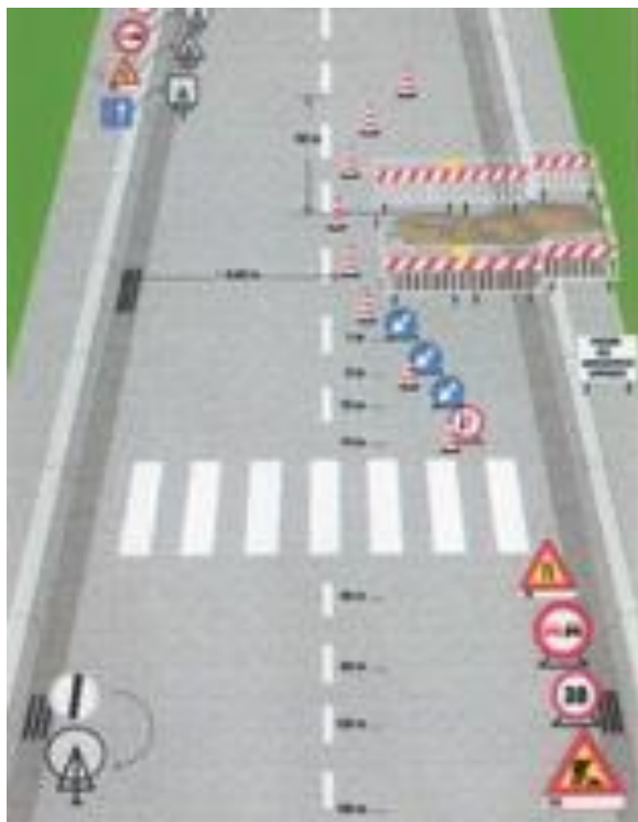
Figura 32 Esempio di organizzazione cantiere stradale
