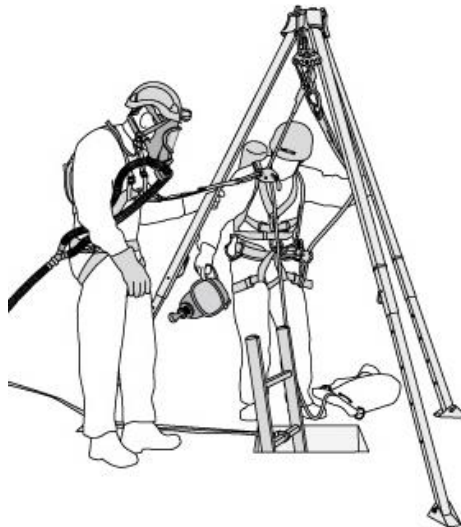
Figura 5 - Assistenza lavori in spazi confinati
