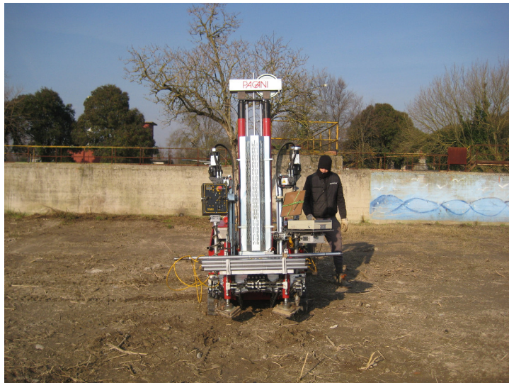
Foto 2: Esecuzione della prova CPTU2
