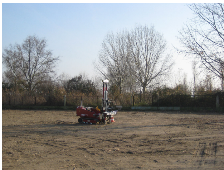
Foto 3: Esecuzione della prova CPTU3
