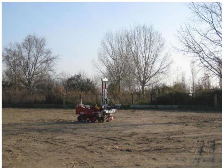
Foto 3: Esecuzione della prova CPTU3
