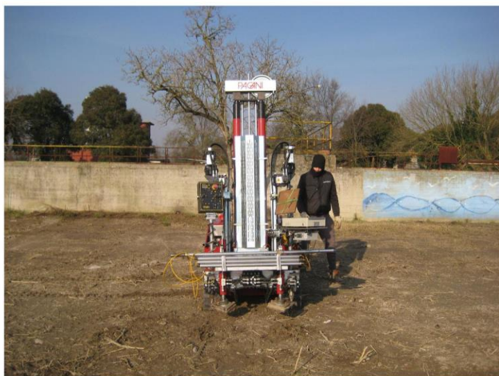
Foto 2: Esecuzione della prova CPTU2
