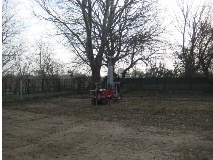
Foto 1: Esecuzione della prova CPTU1
