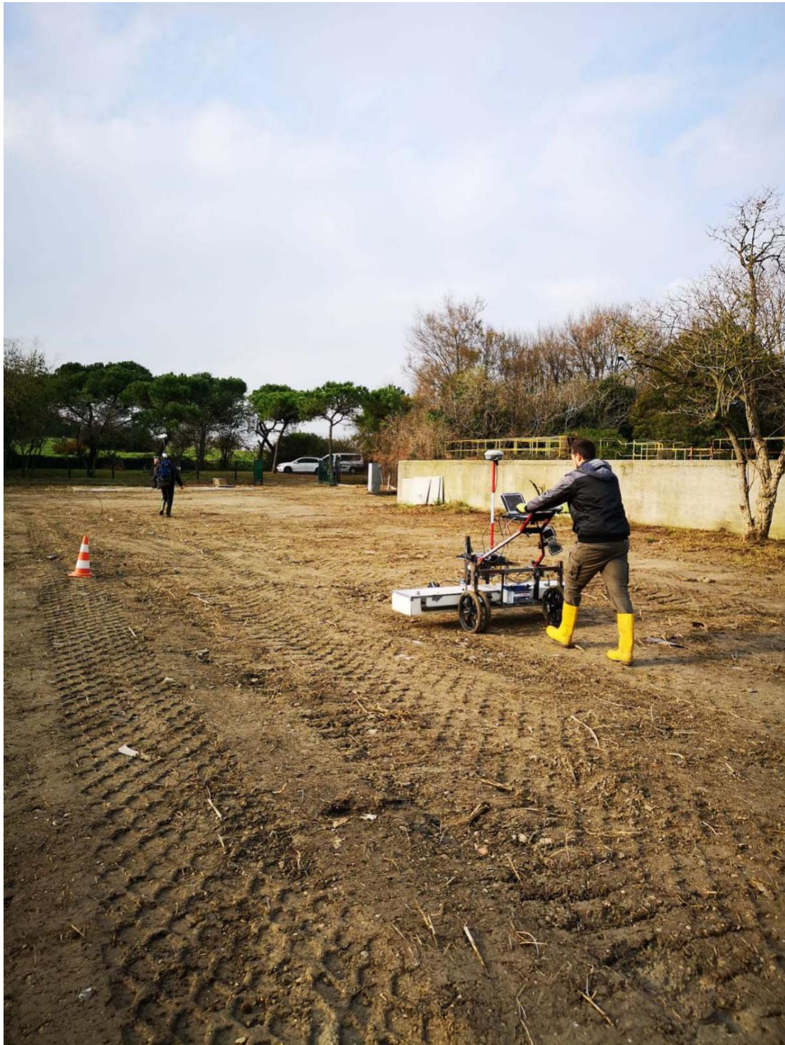
Foto - Esecuzione del rilievo Georadar con Georadar IDS Stream-X
