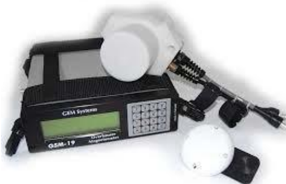
Immagine 06 - Consolle d'acquisizione e sensore del magnetometro GEM GSM-19 Overhauser
