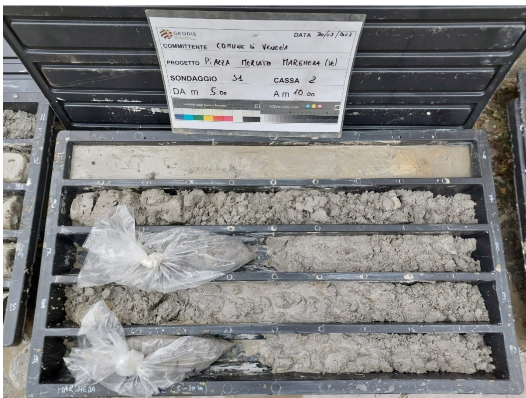
Fig.4 - Cassetta catalogatrice sondaggio S1 da 5 a 10 m.
