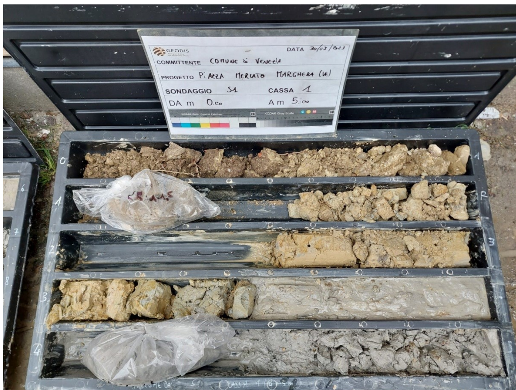
Fig. 3 - Cassetta catalogatrice sondaggio S1 da 0 a 5 m.
