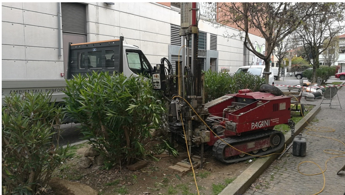
Fig. 1 - Esecuzione prova CPTU1.
