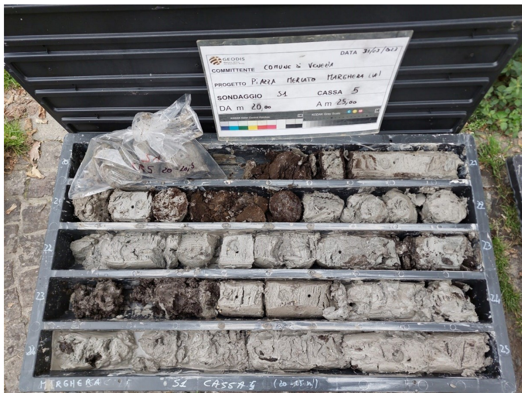
Fig. 7 - Cassetta catalogatrice sondaggio S1 da 20 a 25 m.
