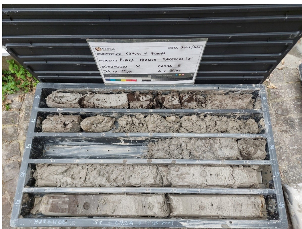
Fig. 8 - Cassetta catalogatrice sondaggio S1 da 25 a 30 m.
