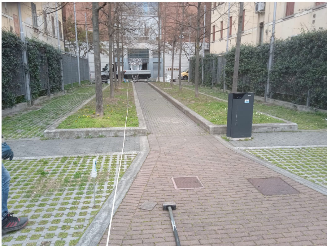
Fig. 9 - Esecuzione stendimento MASW.
