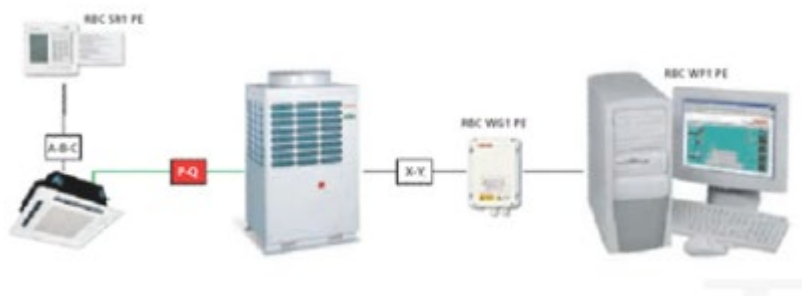
Figura 5 – Gestione di un impianto VRF/VRV
