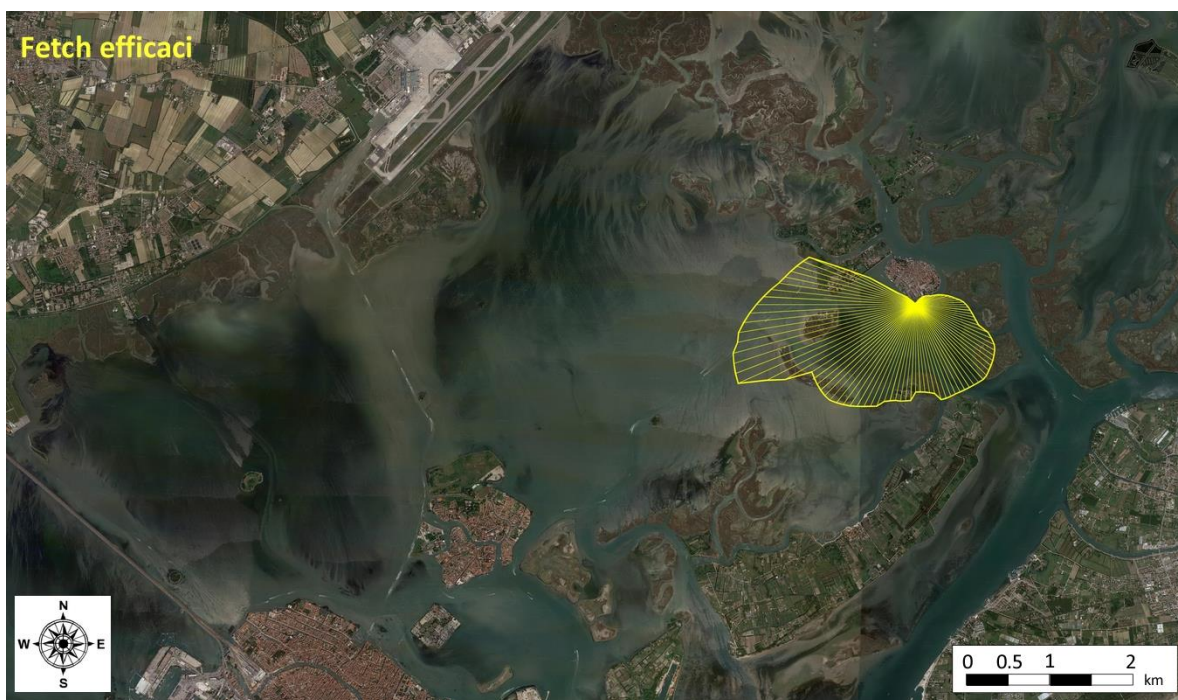
Fig. 3.3 – Fetch geografici (sopra) ed efficaci (sotto) per il paraggio in esame.
