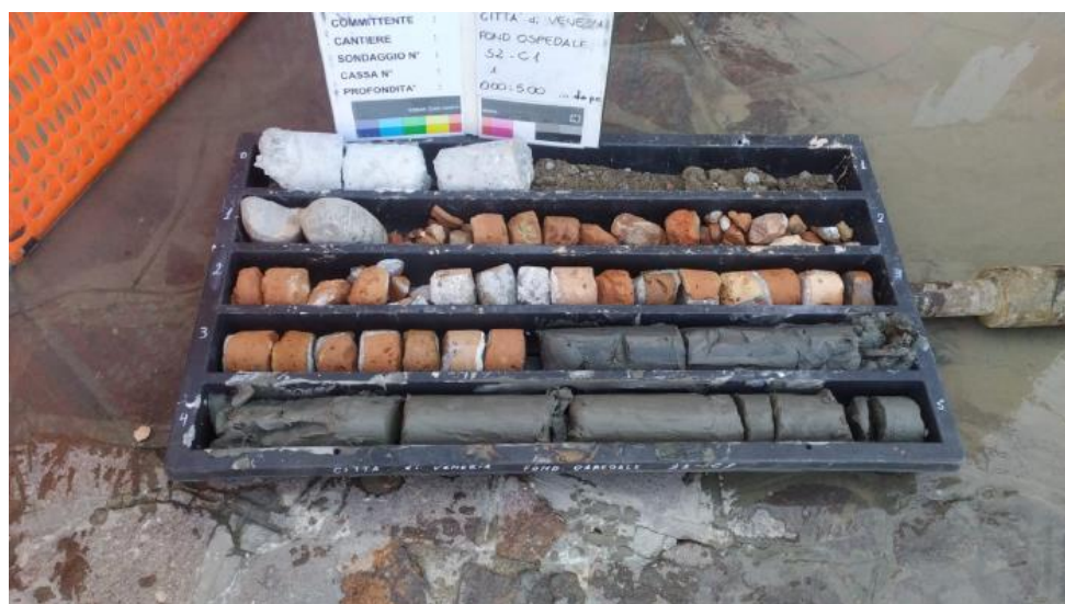
Figura 7.4: Cassetta di catalogazione del sondaggio S2C1 per la verifica della consistenza e geometria del muro di sponda
