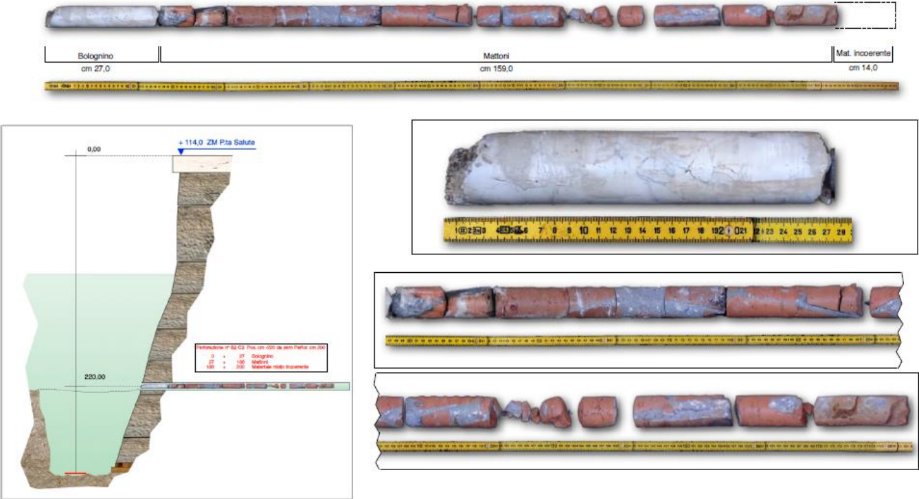
Figura 7.2: Sezione tipologica con dettagli delle carote orizzontali eseguite
