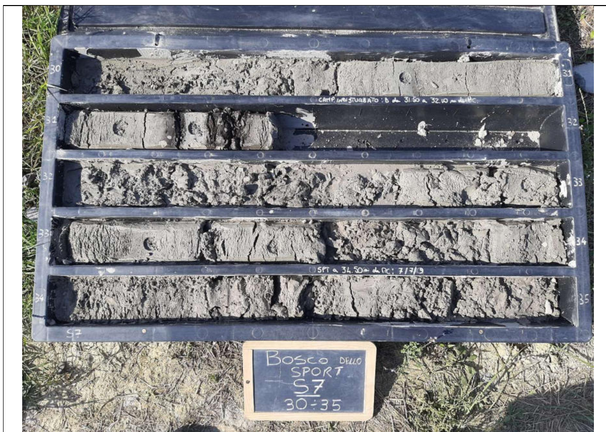
Sondaggio S7, foto cassetta n. 7 da 30 a 35 m
