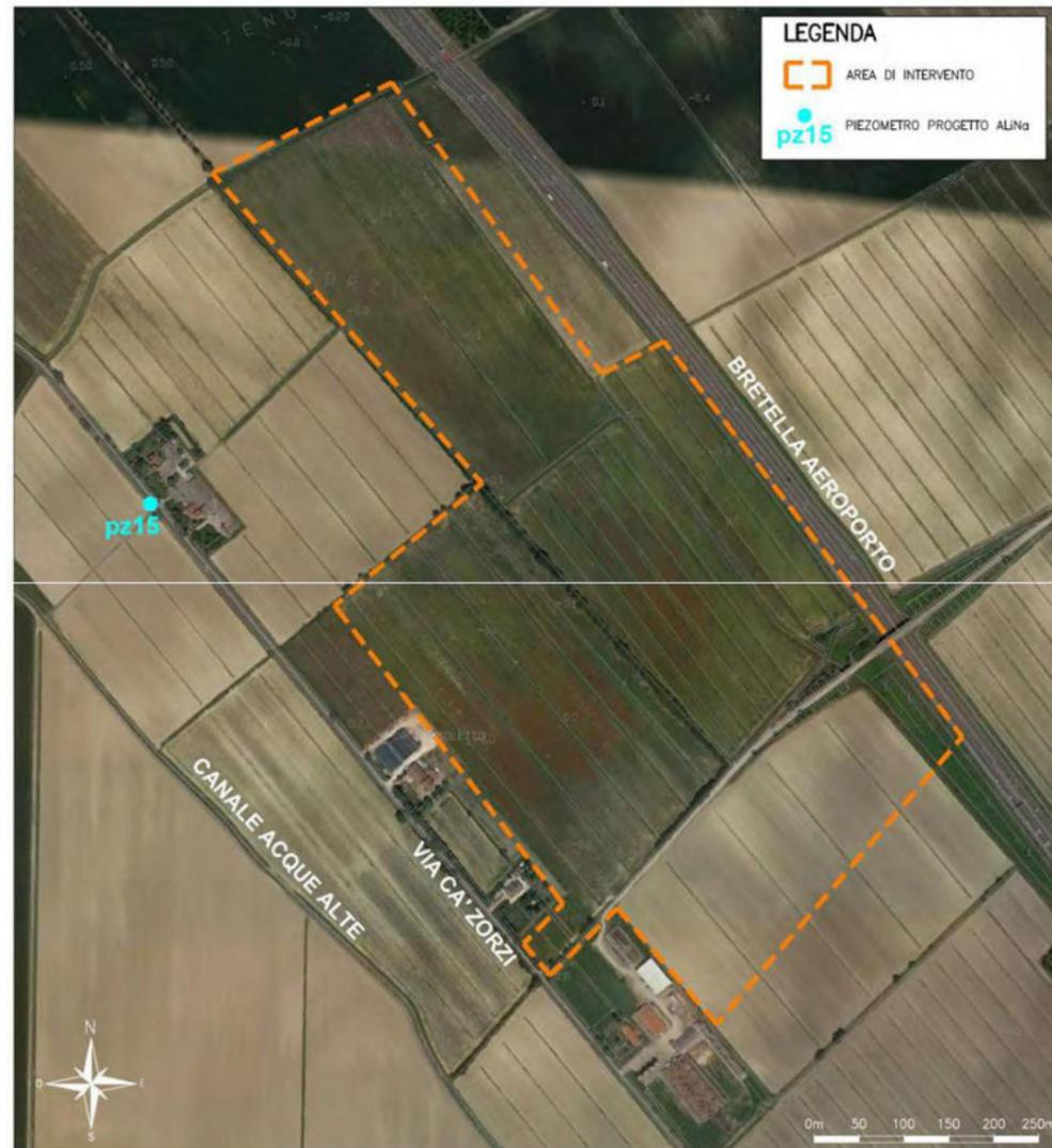
Figura 8 Ubicazione del piezometro P15 del progetto ALiNa rispetto all'area di intervento
