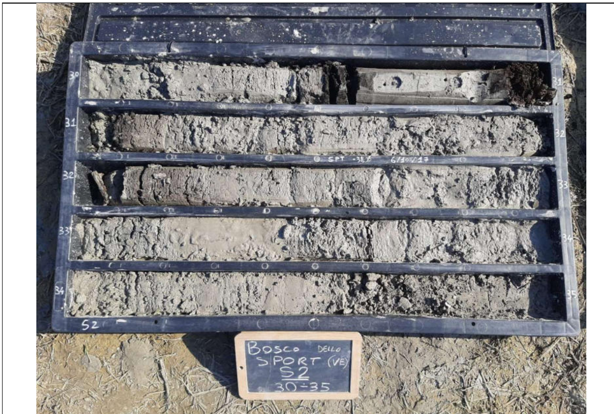
Sondaggio S2, foto cassetta n. 7 da 30 a 35 m
