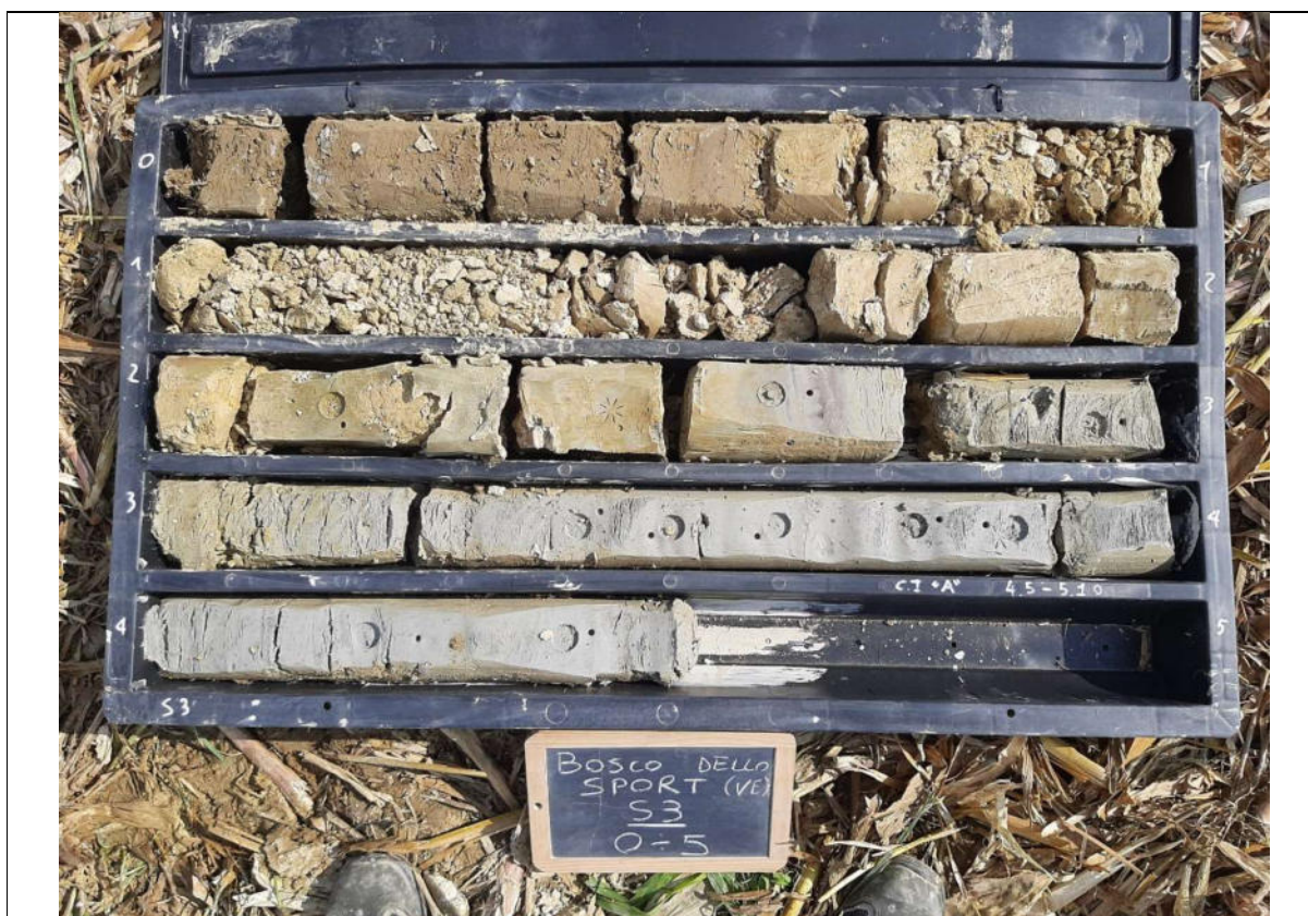
Sondaggio S3, foto cassetta n. 1 da 0 a 5 m
