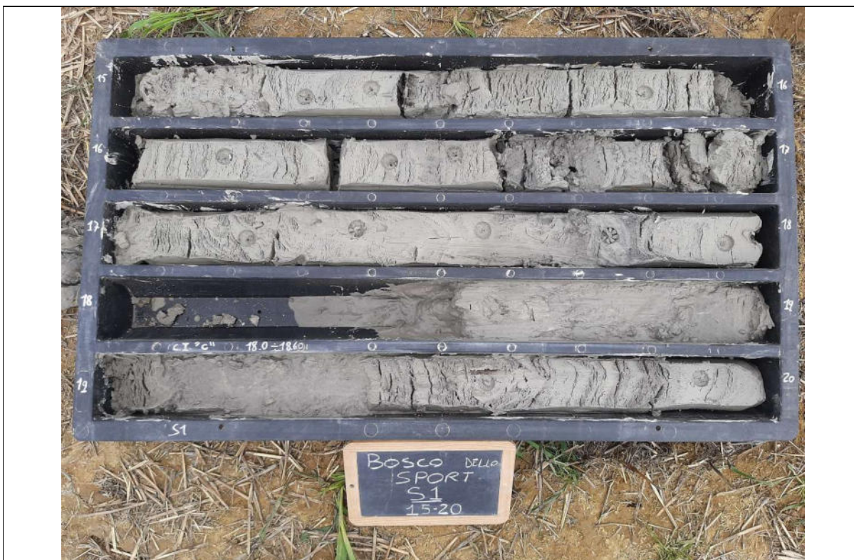
Sondaggio S1, foto cassetta n. 4 da 15 a 20 m
