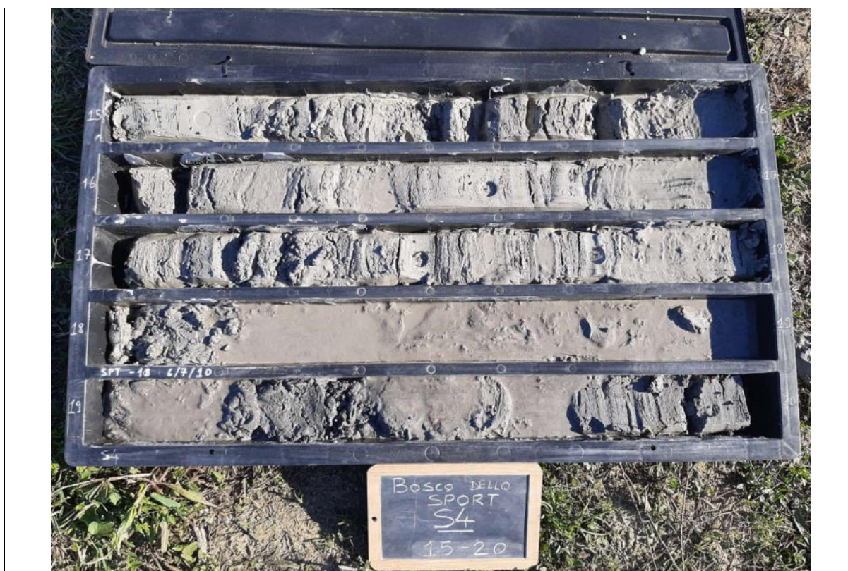
Sondaggio S4, foto cassetta n. 4 da 15 a 20 m
