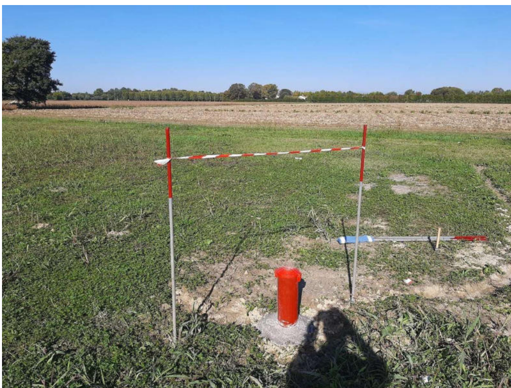
Foto sistemazione finale pozzetto rosso piezometro Casagrande
