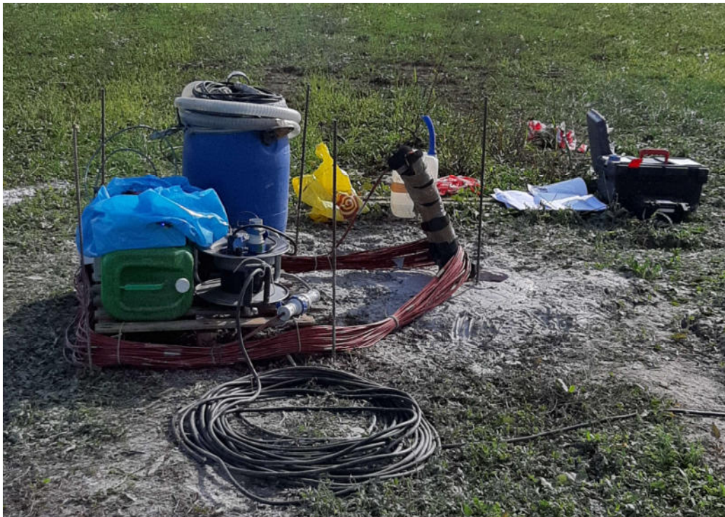
Figura 4: Sistema GEOSniff® AUTO TRT Kit installato sulla sonda geotermica SG01
