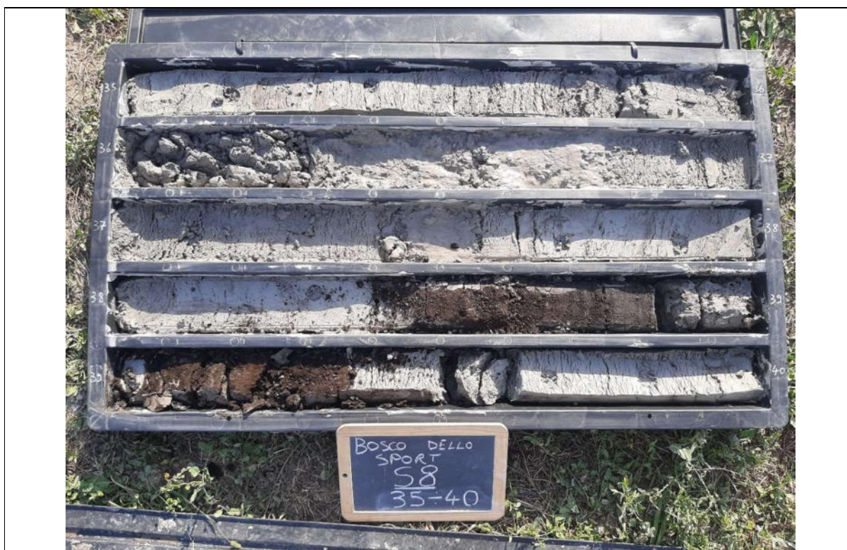
Sondaggio S8, foto cassetta n. 8 da 35 a 40 m
