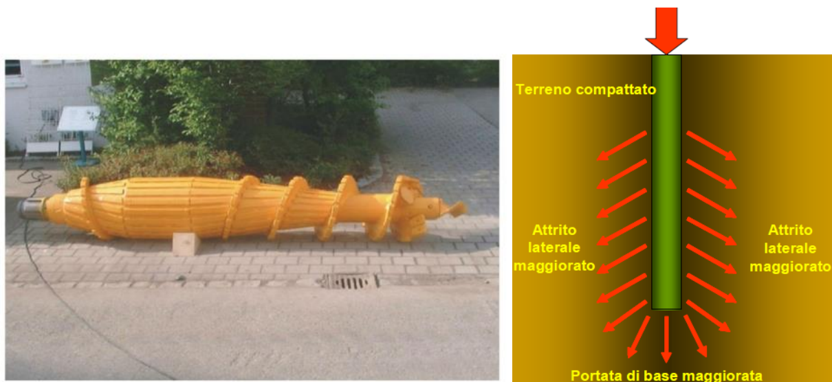
FIGURA 52 – COLONNE FDP – UTENSILE DI SCAVO
