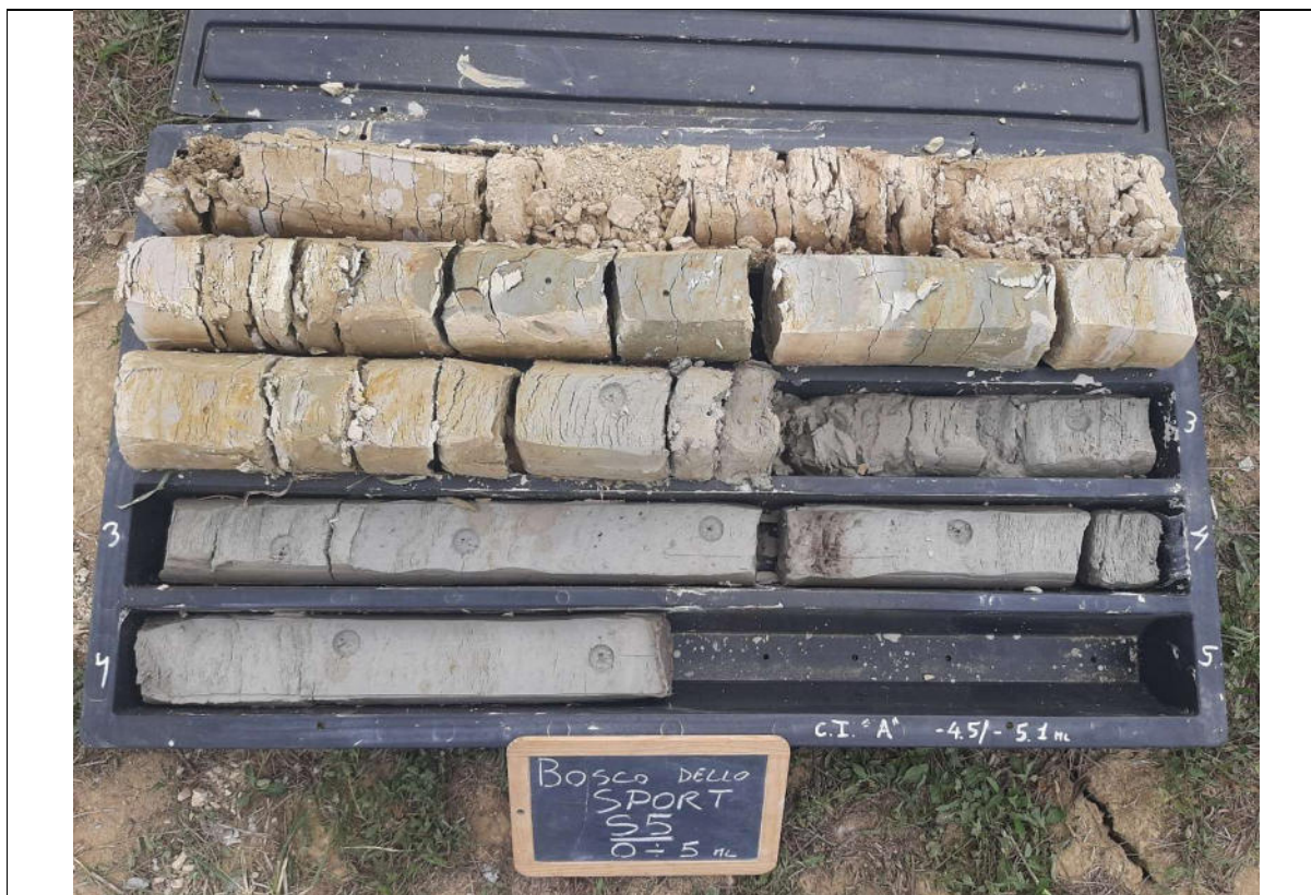
Sondaggio S5, foto cassetta n. 1 da 0 a 5 m
