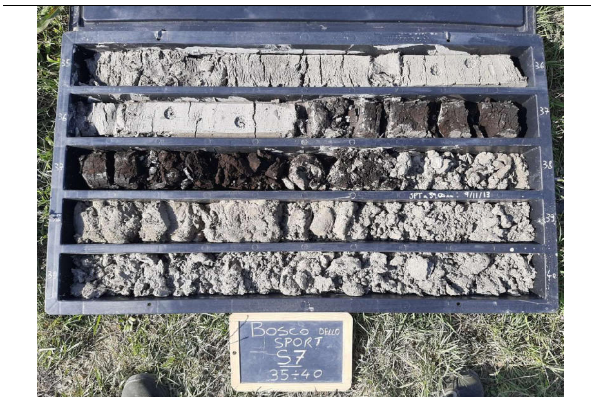
Sondaggio S7, foto cassetta n. 8 da 35 a 40 m
