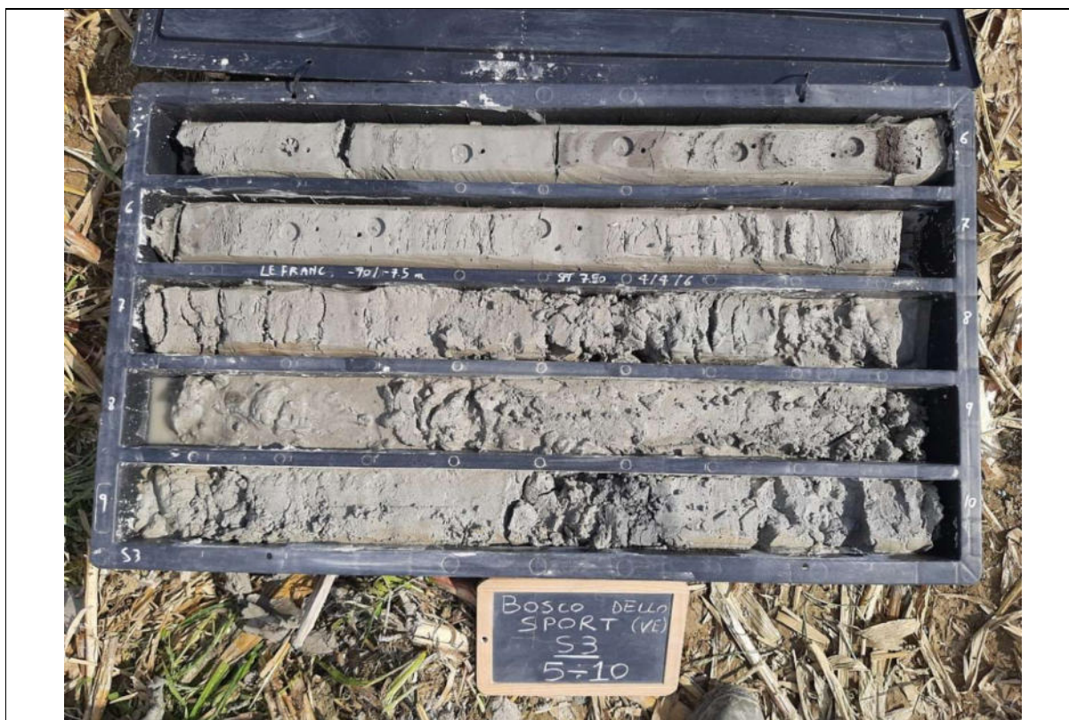
Sondaggio S3, foto cassetta n. 2 da 5 a 10 m
