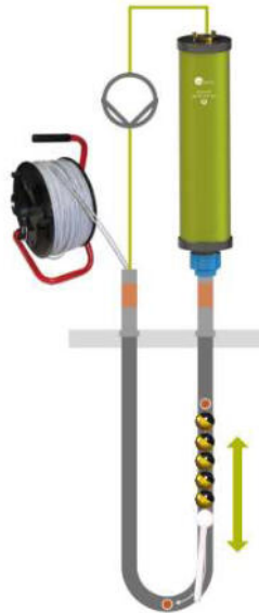
Figura 2: Schema di funzionamento del GEOsniff eTRT
