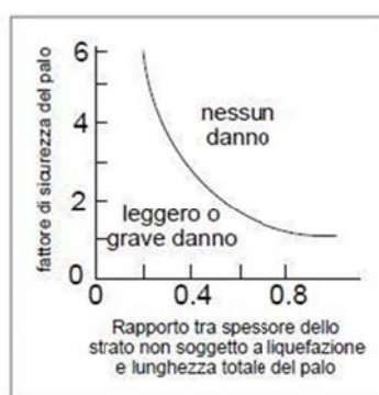
Figura 65: schema comprendente in ascissa il rapporto tra spessore dello strato non soggetto a liquefazione e lunghezza del palo totale, e in ordinata il Fattore di Sicurezza del palo. I possibili danni si hanno quando il F_s è attorno a 1 – 2 e il rapporto di ordinata pari a 0.2 – 0.4 (ovvero lunghezze strato non liquefacibile minore di metà della lunghezza del palo).
