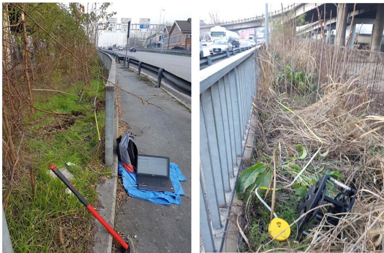
FOTO 7: stendimento di sismica MASW 2.
