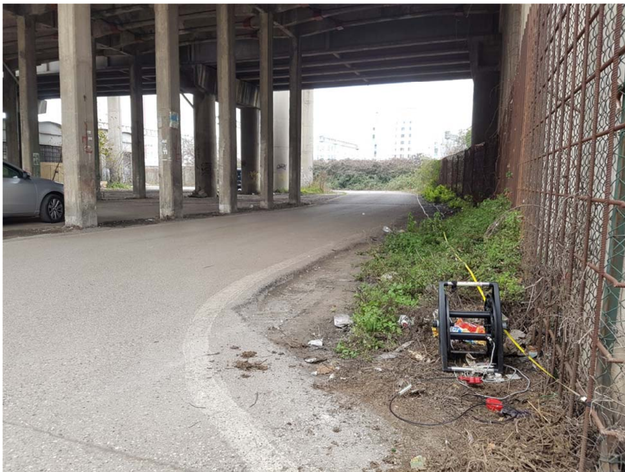
Figura 29: Indagine MASW presso Via della Pila – Marghera (VE), al di sotto del cavalcavia superiore.
