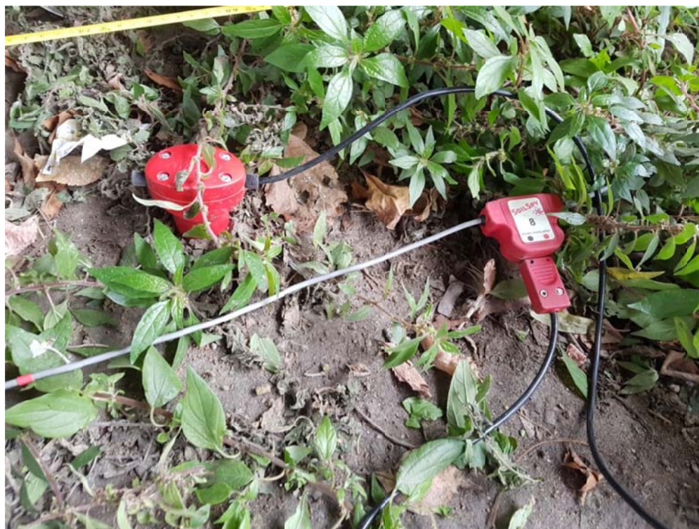
FOTO 8 : dettaglio su apparecchi ricevitori delle onde sismiche, Geofoni da 4,5 Hz.
