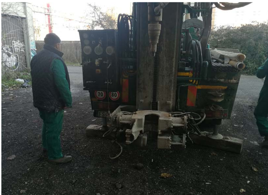
Figura 31: esecuzione indagine penetrometrica CPTU con penetrometro –gouda da 200 kN, presso la porzione sottostante il cavalcavia superiore di Marghera (VE) lungo Via della Pila
