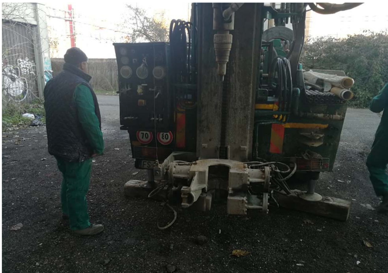
FOTO 3 : Prova Penetrometrica Statica CPTU 1.
