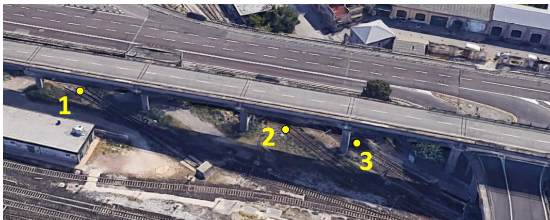
Figura 3 - Binari interferenti con le attività di cantiere e lavorazioni sull'impalcato
