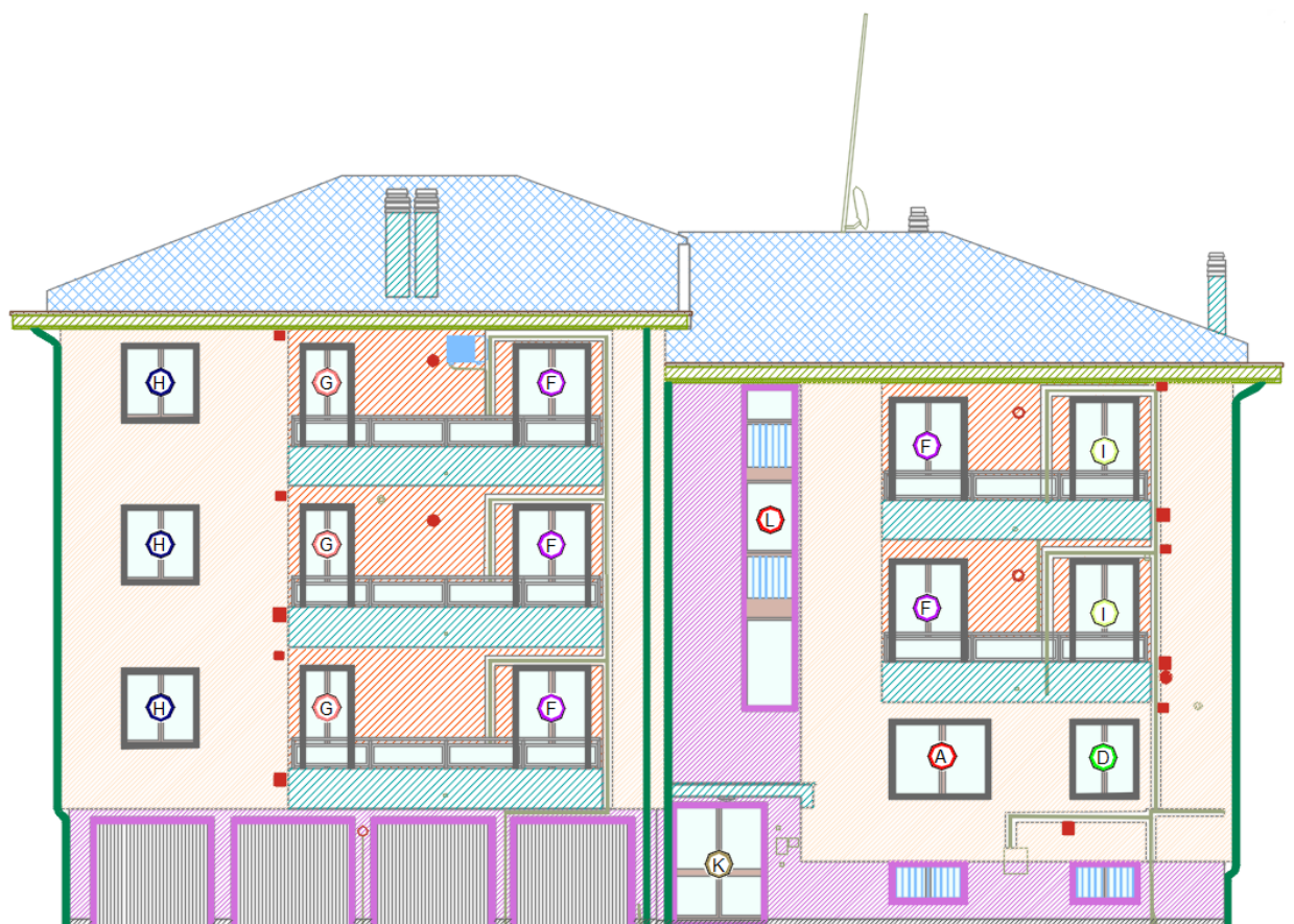
Figura 9 – Prospetto-tipo con individuazione degli interventi proposti
