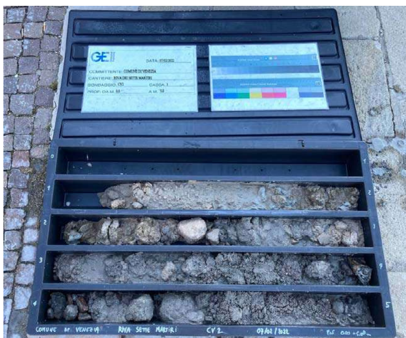
SONDAGGIO CV2 – CASSA 1 – DA 0,0 A 5,0 M
