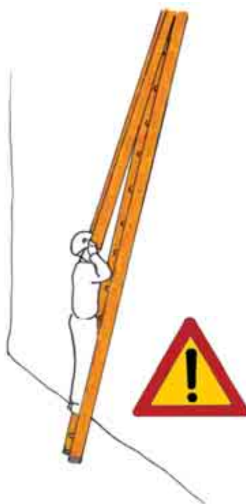
Fig. 39 - Modalità errata di montaggio
