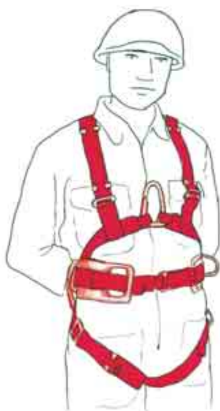
Fig. 15 - Imbracatura per il corpo con cintura di posizionamento integrata ed attacco sternale
