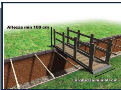
Passerelle per attraversamento dello scavo
