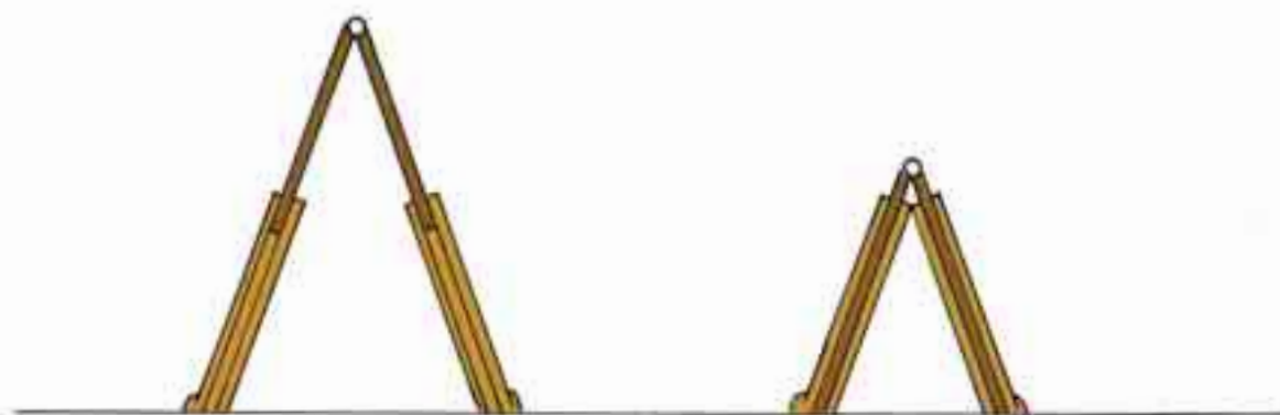
Fig. 47 - Scala trasformabile telescopica in posizione doppia
