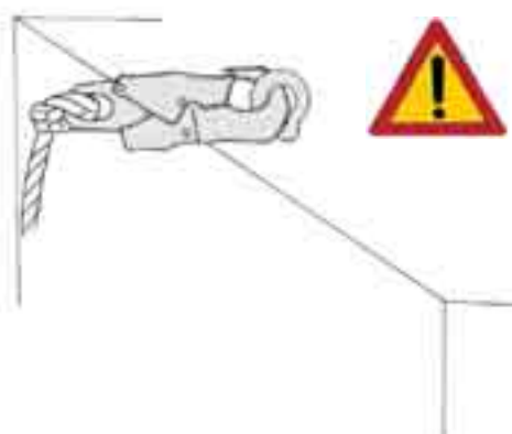
Fig. 41 - Elementi di attacco usati impropriamente
