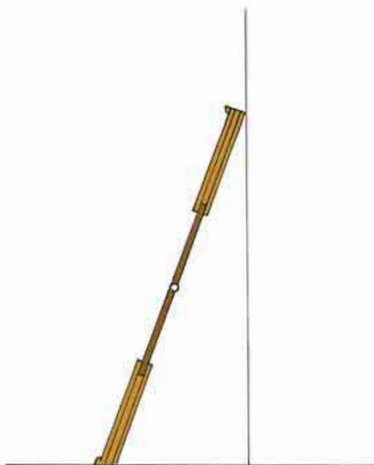
Fig. 48 - Scala trasformabile telescopica in posizione di appoggio
