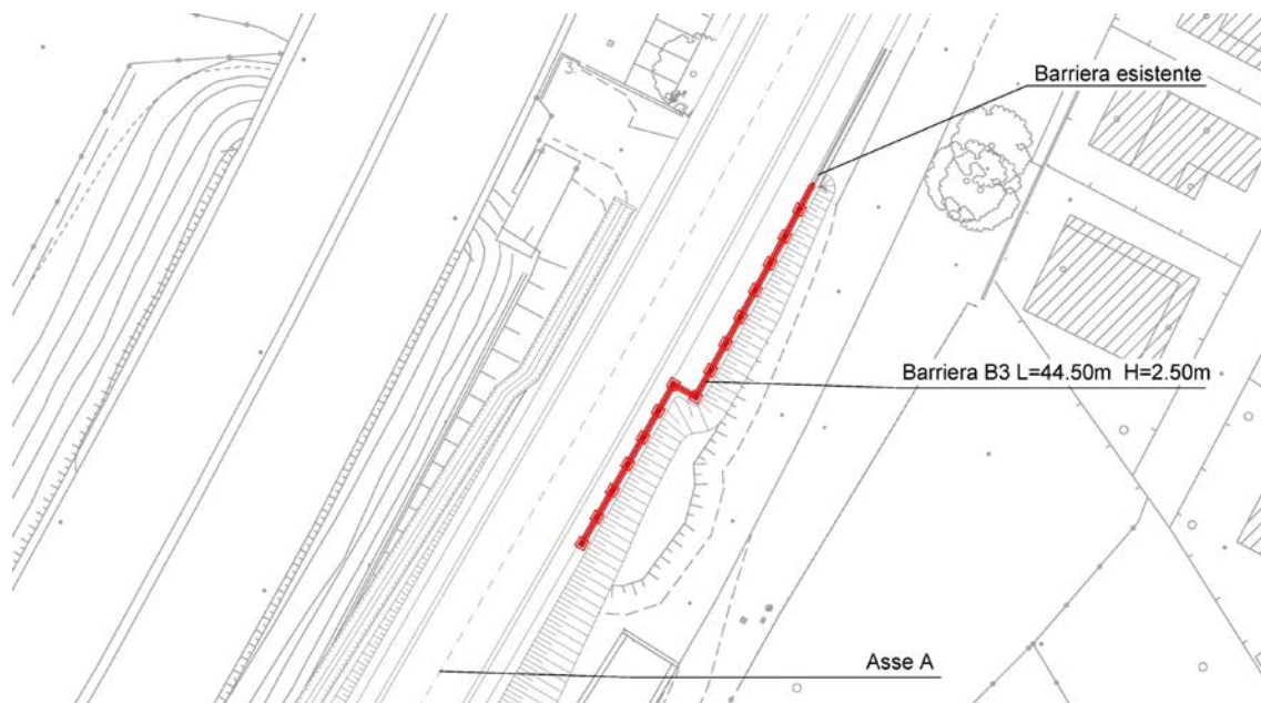
Figura 7.34 –Localizzazione barriere acustiche – Rilevato di accesso nord ponte Marzenego
