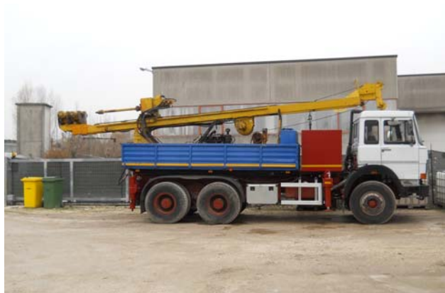
Figura 2. Perforatrice autocarrata Atlas CopcoA65
