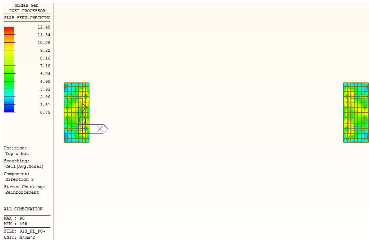
Figura 81 Fondazioni. Tensioni nell'acciaio inferiori e superiori direzione 2 (MPa)
