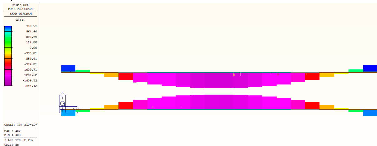
Figura 91 Modello FEM, sforzo assiale travi reticolari briglia superiore nell'involuppo delle combinazioni SLU-SLV
