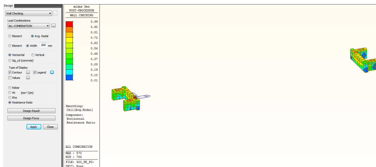
Figura 86 Setti. Rapporti di resistenza per armature orizzontali
